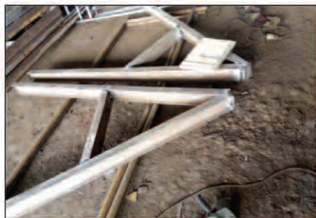
Photo 2 : Assemblage des IPN 120 en atelier
