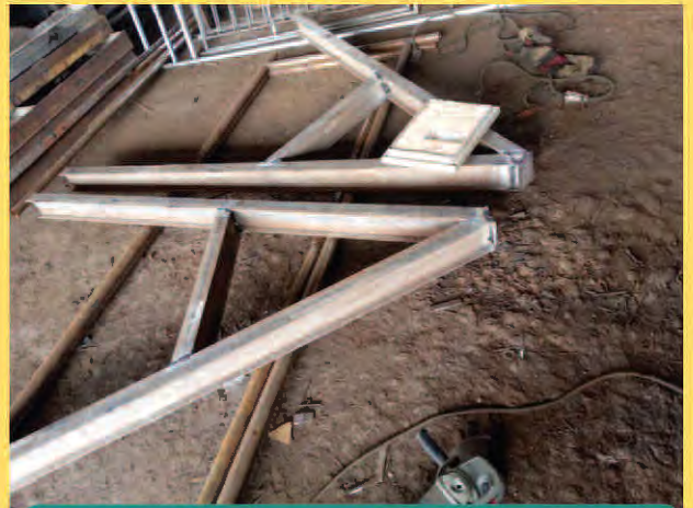
Assemblage des IPN 120 en atelier
